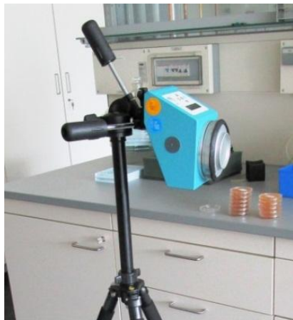
Abbildung 2: Versuchsaufbau zur Luftkeimsammlung (Quelle: TLV)
